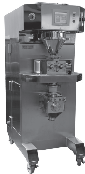
写真1 ローラーコンパクター「TF」（フロイント産業）
